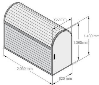
Fahrradgarage M3 Technische Abmessungen
