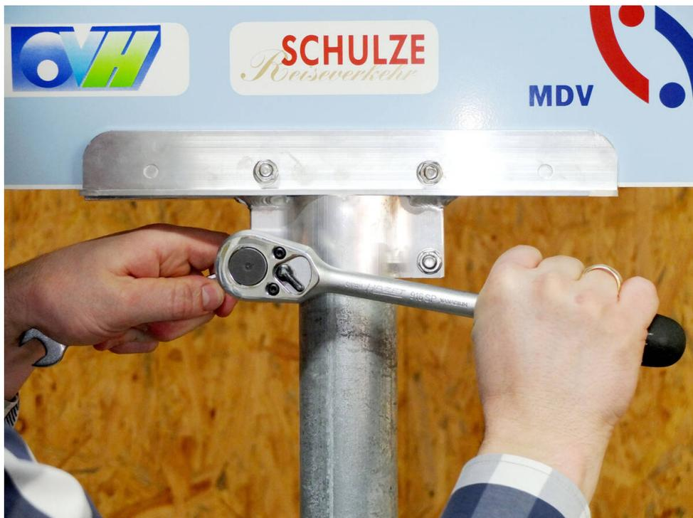
Einfacher Schildwechsel: Schrauben einseitig lösen ...
