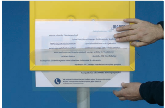
▲ Der Fahrplan kann nun entlang des Werkzeugs nach unten geschoben und leicht aus dem Rahmen entfernt werden.
