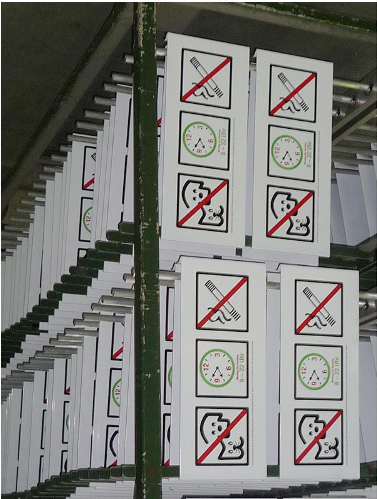
Einzelne Modulschilder im Siebdruckverfahren bedruckt
