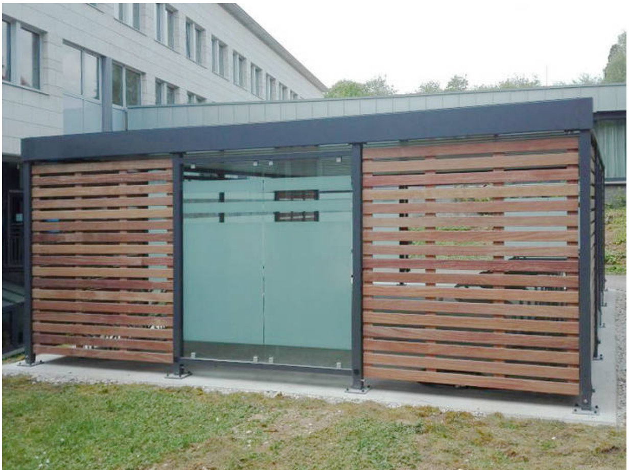
Fahrradüberdachung PROTECT Seitenwand mit Glas- und Holzelementen
