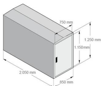
Fahrradgarage M1 Technische Abmessungen
