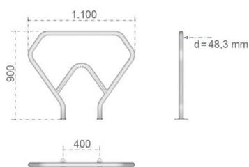
Fahrradbügel · Anlehnparkter Typ WM6 Technische Abmessungen
