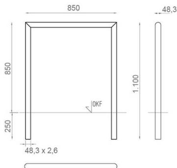
Fahrradbügel · Anlehnparker Typ U-R Technische Abmessungen
