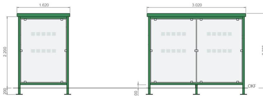
Flachdach-Pavillon Technische Abmessungen
