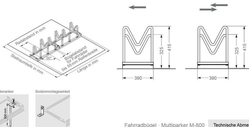
Fahrradbügel · Multiparker M-800 Technische Abmessungen
