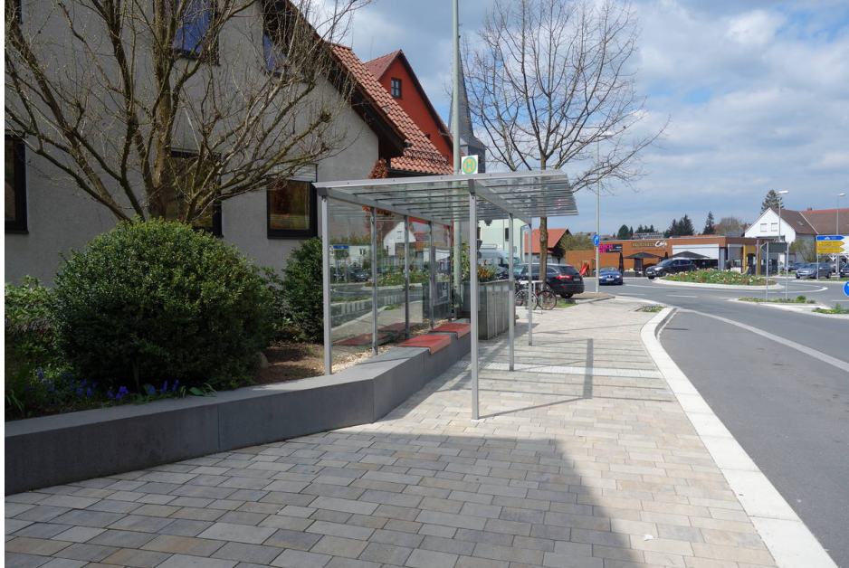
Wartehalle System X mit Dacheindeckung in VSG
