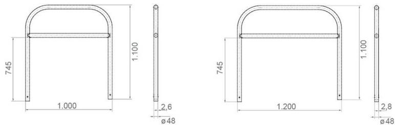
Fahrradbügel · Anlehnarker Typ U-K Technische Abmessungen
