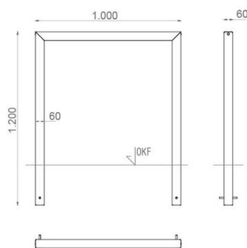
Fahrradbügel · Anlehnparkertyp U-V Technische Abmessungen
