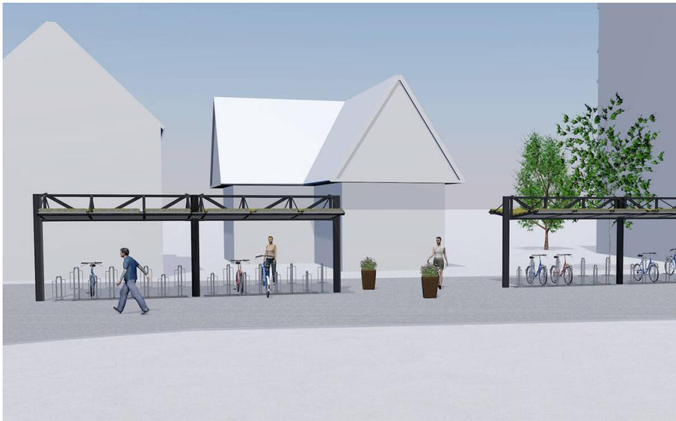
Fahrradüberdachung Typ O mit Gitterträger und Gründach
