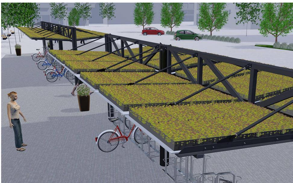
Vorbepflanztes Gründach (Sedummischung) der Fahrradüberdachung System O doppelzeilig
