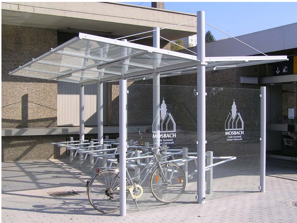
Ansicht einer doppelzeilige Fahrradabstellanlage Typ O mit Mittelstützen und Seitenwänden in Mosbach
