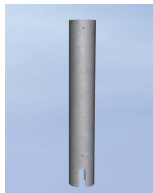
Adapter für 60er Mast auf 76er Bodenhülse Stahladapter, verzinkt einschl. Aussparung Verdrehsicherung zur Nutzung von bereits vorhandenen Fundamente mit 76er Bodenhülsen zur Einstellung 60er Maste
