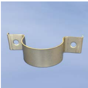
F3 Schelle F3 d= 60 mm, VA, einzeln für Mastdurchmesser 60,3 mm Material: Edelstahl
